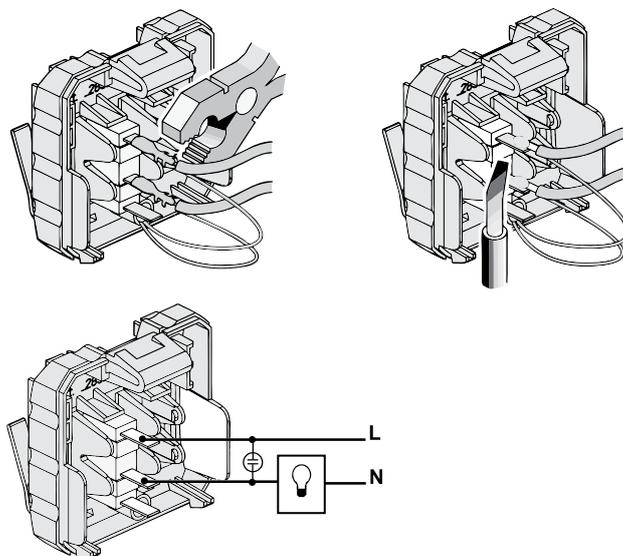
Винтовые клеммы для кабеля сечением 2,5 мм<sup>2</sup>.
