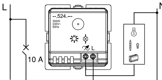
Винтовые клеммы для проводников сечением до 2,5 мм<sup>2</sup>, возможно подключение до 5 кнопок для ручного управления.
