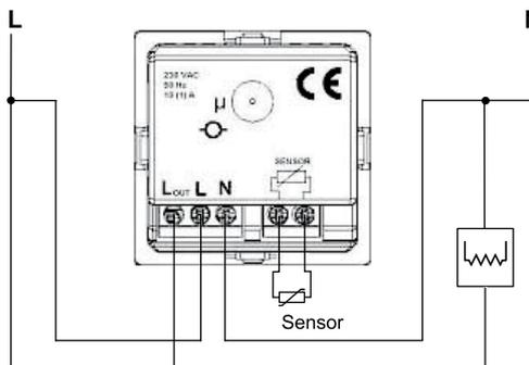
Винтовые клеммы для проводников 2x2,5 мм<sup>2</sup>
