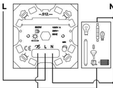
Винтовые зажимы для проводников сечением до 2,5 мм<sup>2</sup>
