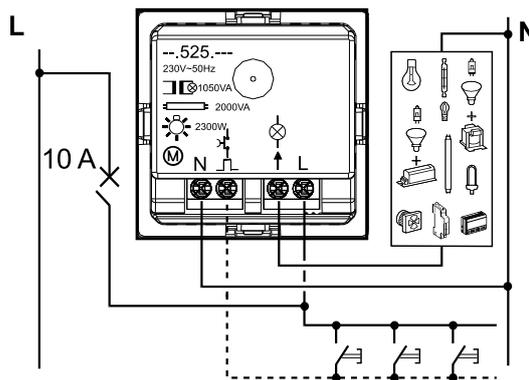
Винтовые клеммы для проводников сечением до 2,5 мм<sup>2</sup>, возможно подключение до 5 кнопок для ручного управления.
