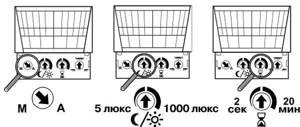
M: manual: ручной режим, нагрузка включается кнопкой
