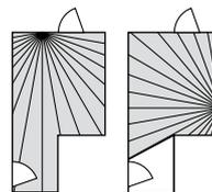
Устанавливайте датчик движения поперек направления движения, чтобы траектории лучей пересекались по возможности под прямым углом. Датчик движения необходимо жестко закреплять в месте монтажа для обеспечения точной зоны охвата и оптимального срабатывания.
