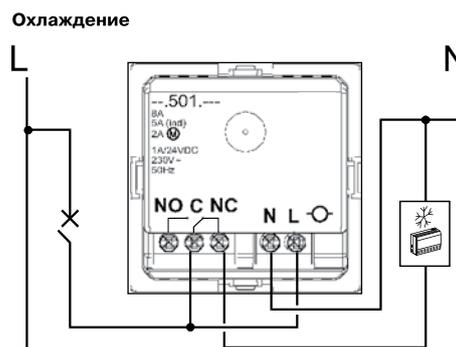
С — , L — фаза, N — нейтраль, NO — нормально открытый, NC — нормально закрытый. Клеммы предназначены для подключения проводов сечением до 2,5 мм<sup>2</sup>.
