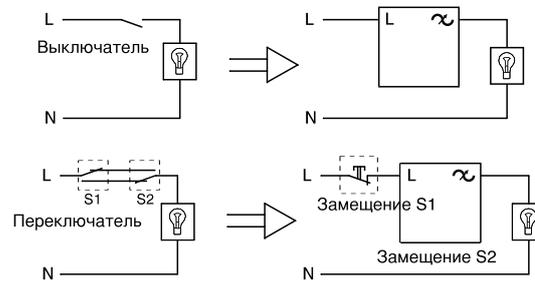
При кратковременном размыкании питающей фазы датчика движения с помощью кнопки, датчик включает свет на время своей уставки.
