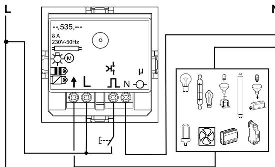
Клеммы предназначены для проводов сечением 2,5 мм<sup>2</sup>.
