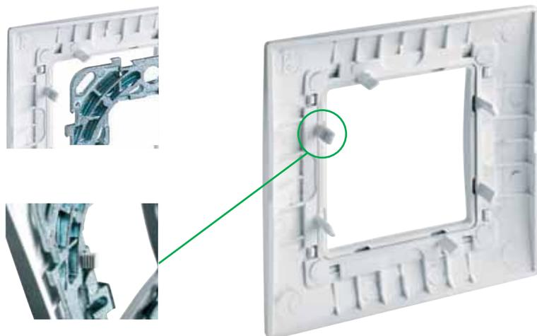
Рамки защелкиваются в четырех точках крепления простым нажатием, обеспечивая плотное прилегание даже при неровных стенах. Специальная система крепления позволяет установить рамки и в случае, если коробка выступает из стены на 0,75 мм, или утоплена в стене на 2,25 мм
