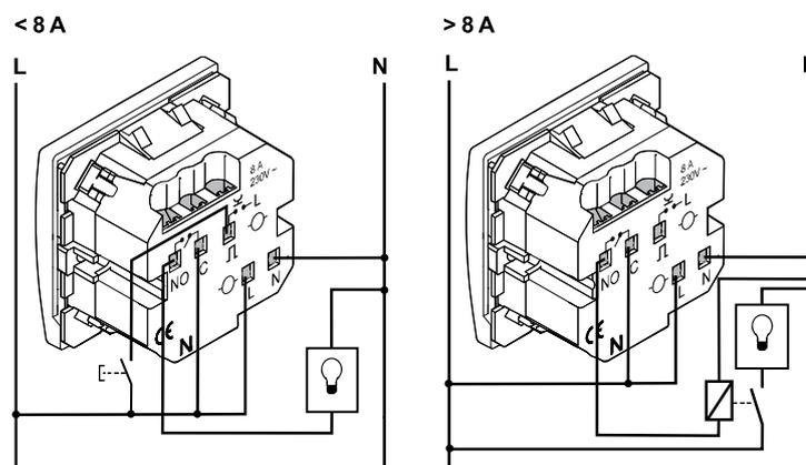
Клеммы предназначены для проводов сечением 2,5 мм<sup>2</sup>.
