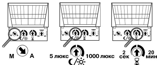
M: manual: ручной режим, нагрузка включается кнопкой
