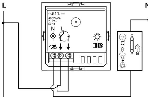
Винтовые зажимы для проводников сечением до 2,5 мм<sup>2</sup>
